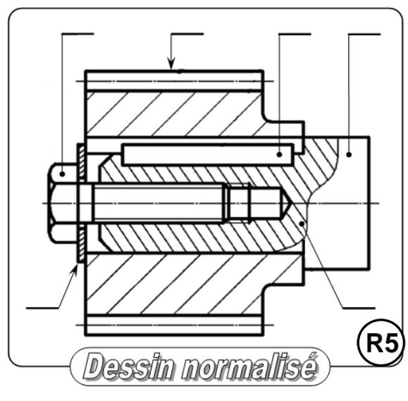
b- Indiquer sur le dessin normalisé les repères des pièces et le nom de la coupe sur l'arbre 1, de la liaison fixe (encastrement) de 2 par rapport à 1.
