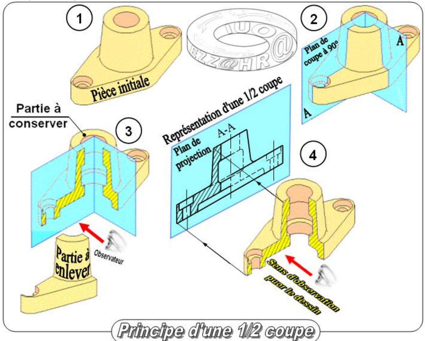
Dans ce mode de représentation la moitié de la vue est dessinée en coupe, afin de définir les formes et les contours intérieurs, alors que l'autre moitié reste en mode de représentation normal pour décrire les formes et les contours extérieurs.
